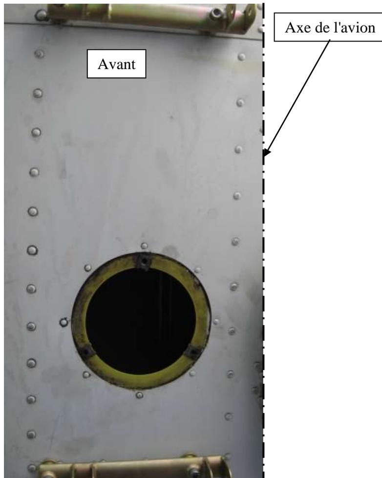
Remettre en place la trappe sous le fuselage.
