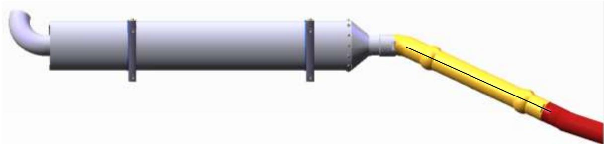
21 - Tracer à l'aide du gabarit la découpe à faire sur le capot inférieur. Vérifier que le traçage correspond bien à la position de l'échappement sur votre avion puis faire la découpe dans le capot. Si le traçage ne correspond pas modifier le afin d'assurer un espace de 5mm minimum entre l'échappement et le capot.
