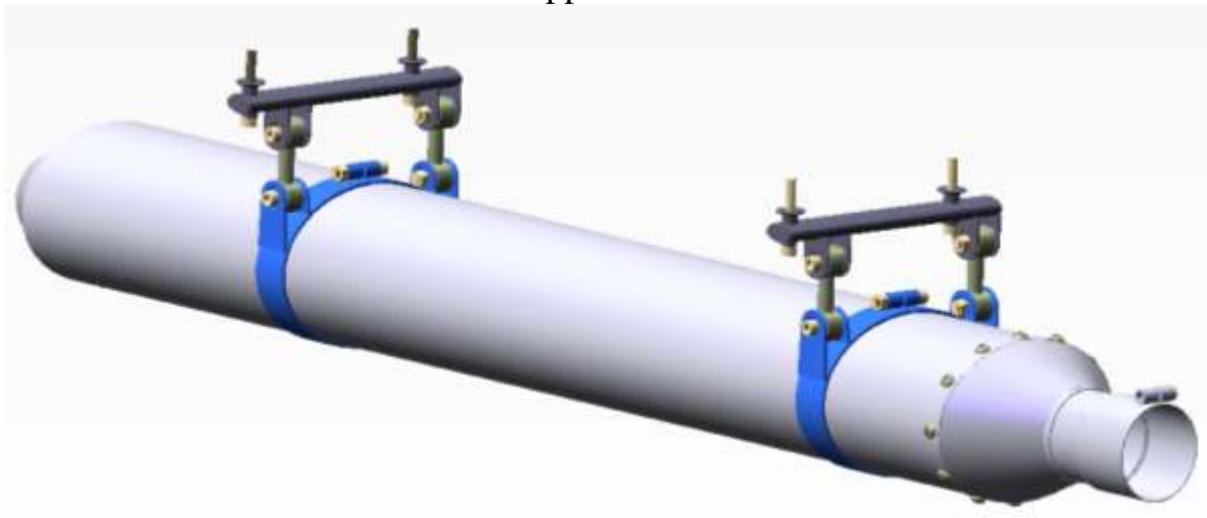
20 - Positionner le tube double rotule puis le silencieux afin d'aligner le tube double rotule, cet alignement est très important, il garantit le bon fonctionnement des rotules :
