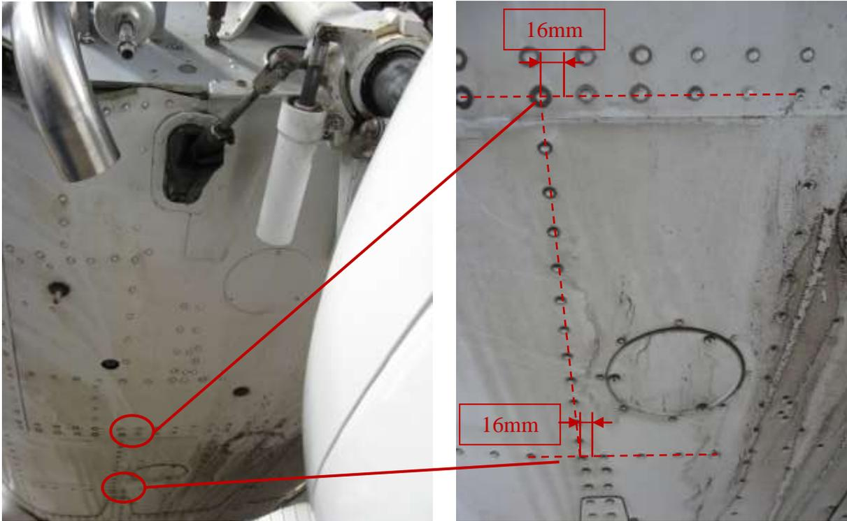
Utiliser le support comme un gabarit afin de percer les 2 autres trous diamètre 6.
