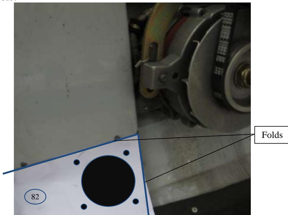
Percer 4 trous diamètre 5 dans la tôle.
