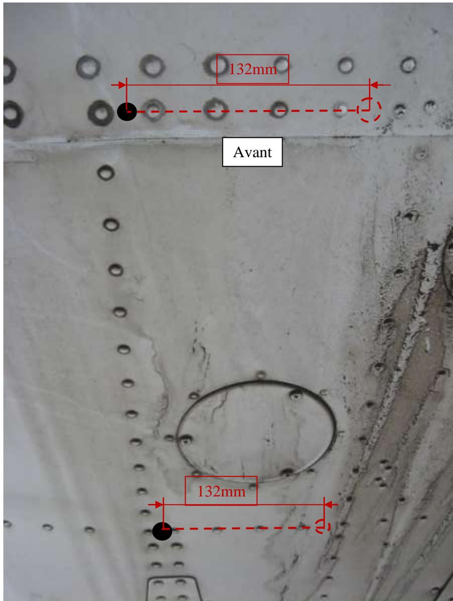
15 - Démonter la trappe sous le fuselage.
