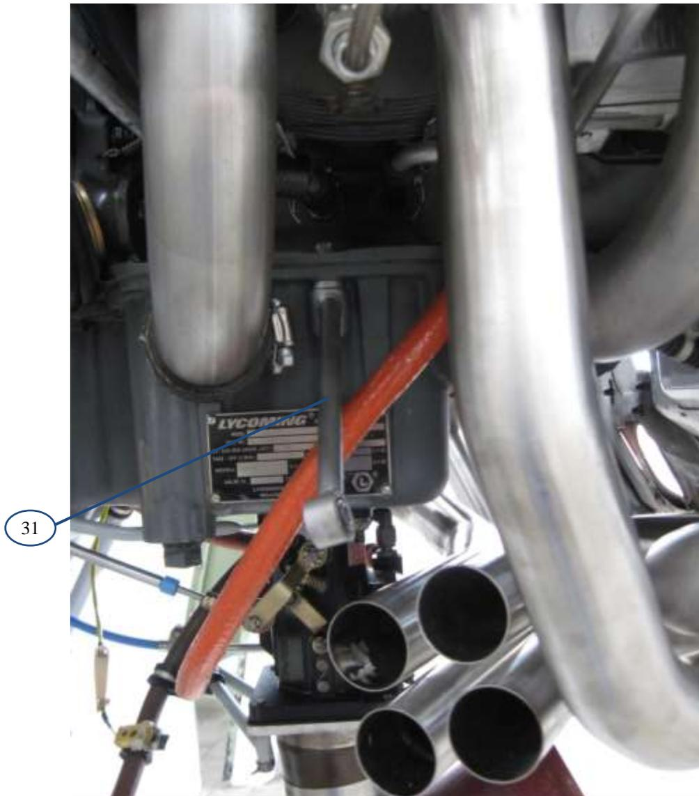
7 - Appliquer de la graisse haute température à l'intérieur du 4en1.
