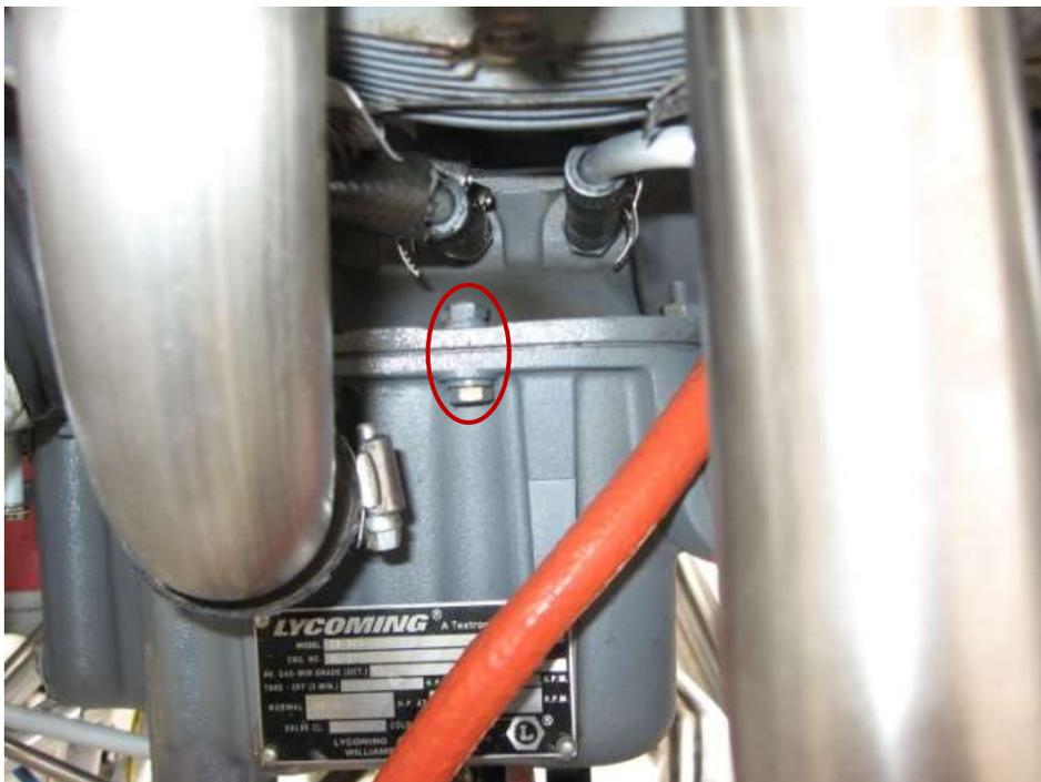
6 - Mettre en place le support de 4en1 (31) sur le carter avec la vis TH M6 x 30mm et l'écrou nylstop.
